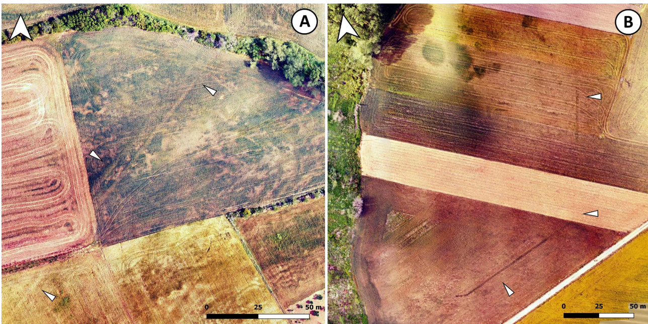
Figura 6: Doble alineamiento documentado en Villa María (A) y recinto de Santa Eulalia (B). Ortofotografías obtenida a partir del procesado fotogramétrico de las imágenes tomadas con UAV. Balance RGB editado y sobremuestreado para realzar las estructuras. Autoría: José M. Costa-García
